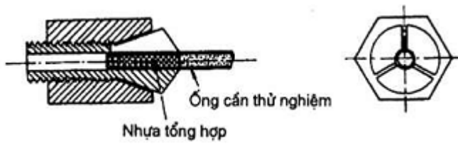
Hình C.2 - Thử nghiệm uốn - Mô tả chi tiết trụ đỡ
